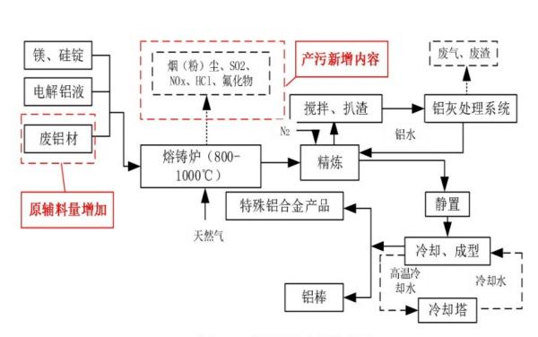
图 1-1 工艺流程及产污节点图
